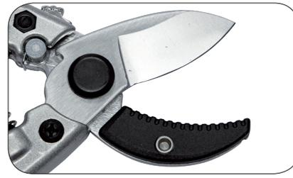
Le sécateur à lames à enclume assure une coupe par écrasement. La lame coupante affûtée sur les deux faces va s'écraser sur la lame opposée, de forme aplatie, que l'on appelle enclume.
